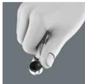
La rotella zigrinata sulla testa di Zyklop Mini 1 permette di avvitare ancora più velocemente. La levetta di inversione, a portata di mano su tutti i modelli Zyklop, consente un rapido cambio del senso di rotazione in modo semplice ed immediato.
