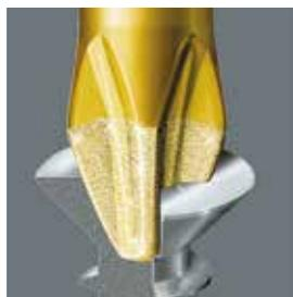
Gli inserti diamantati (Diamond) riducono l'effetto Cam-Out; molto elevato durante l'avvitamento elettrico. Le particelle diamantate riducono notevolmente la pressione necessaria ed il pericolo di slittamento. In questo modo si riduce anche l'affaticamento della mano durante l'avvitamento elettrico.
