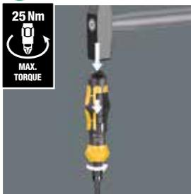
Quando la funzione giravite a battere è attivata, l'impulso del colpo del martello viene convertito in un movimento rotatorio con una coppia di allentamento fino a 25 Nm. La potenza viene trasmessa senza perdite tramite la lama passante.
