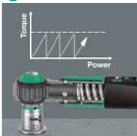
Le chiavi dinamometriche Safe-Torque sono dotate di un meccanismo di blocco a slittamento. Al raggiungimento del valore di coppia impostato l'utensile si blocca e quindi non è possibile applicare una coppia eccessiva.
